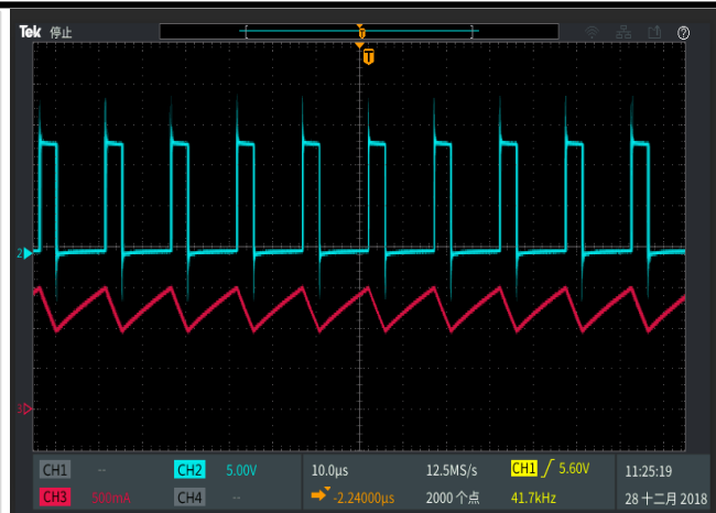
SW 脚与电感电流工作波形
